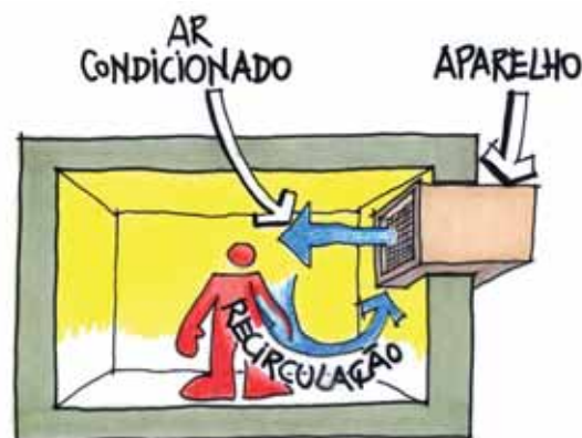
Figura 8-22: Ar condicionado de janela
