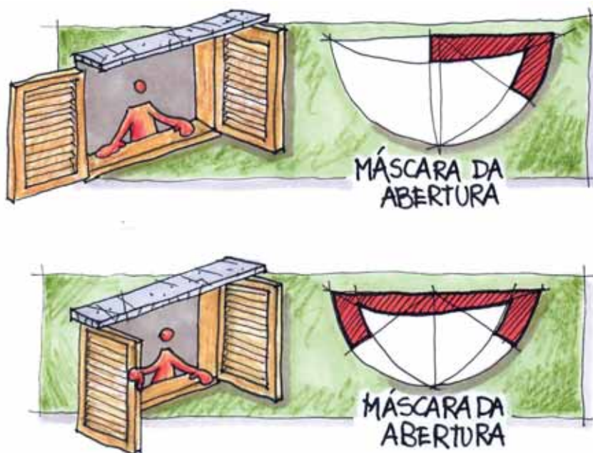
Figura 6-17: Venezianas como direcionadores do ar para o interior e proteção solar vertical
