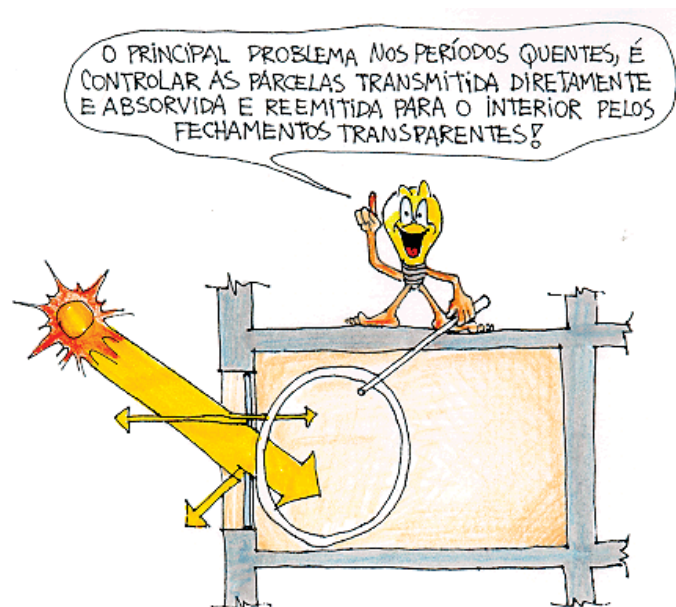
Figura 7-2: Radiação transmitida, absorvida e refletida pelo vidro
