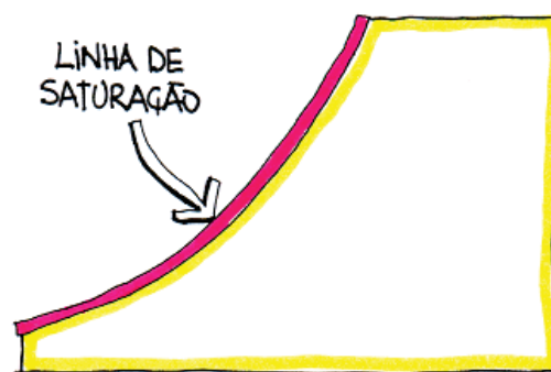
Figura 11-6: Linha de saturação na carta psicrométrica
