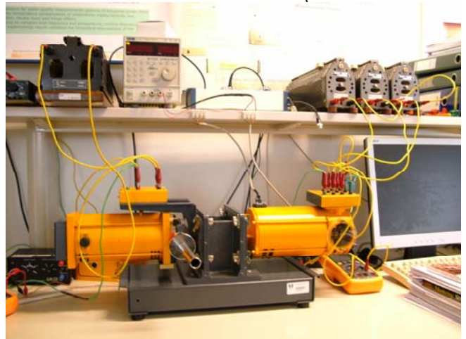
Figura 4. Motor trifásico de indução slip-ring no laboratório do IST.
