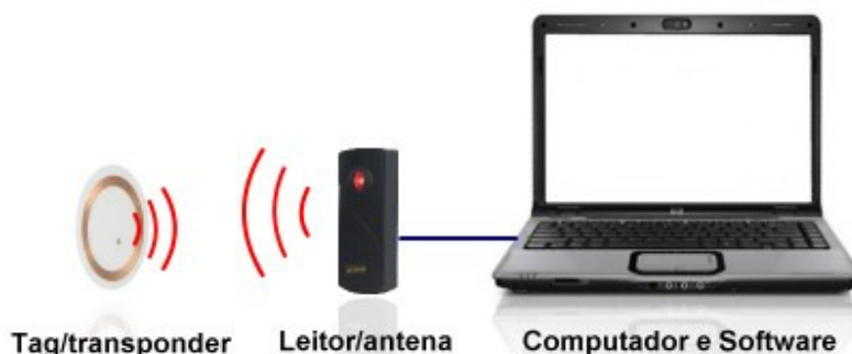
Figura 2. Esquema de um sistema básico de RFID.
