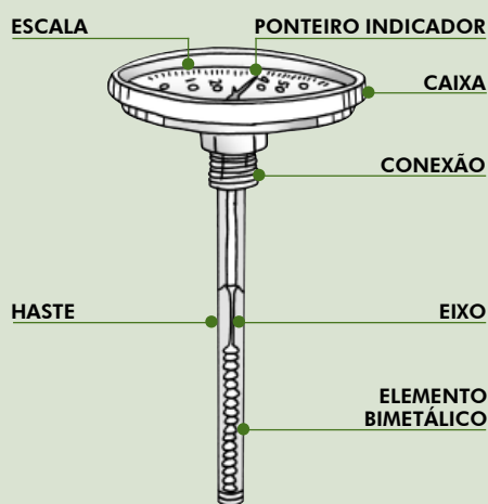
FIGURA 24 TERMÔMETRO BIMETÁLICO
